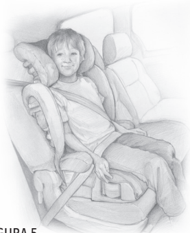
FIGURA 5. Silla elevadora ajustada con cinturón.
